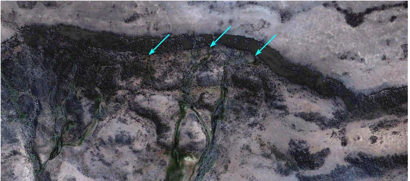
Figura 4-32. Freático aflorando como manantiales (flechas celestes) en el contacto entre las gravas situadas en la base de los Basalto Cóndor Cliff y el techo de las sedimentitas terciarias. Margen norte del valle, a 6,5 km aguas arriba del proyecto de cierre Néstor Kirchner.
