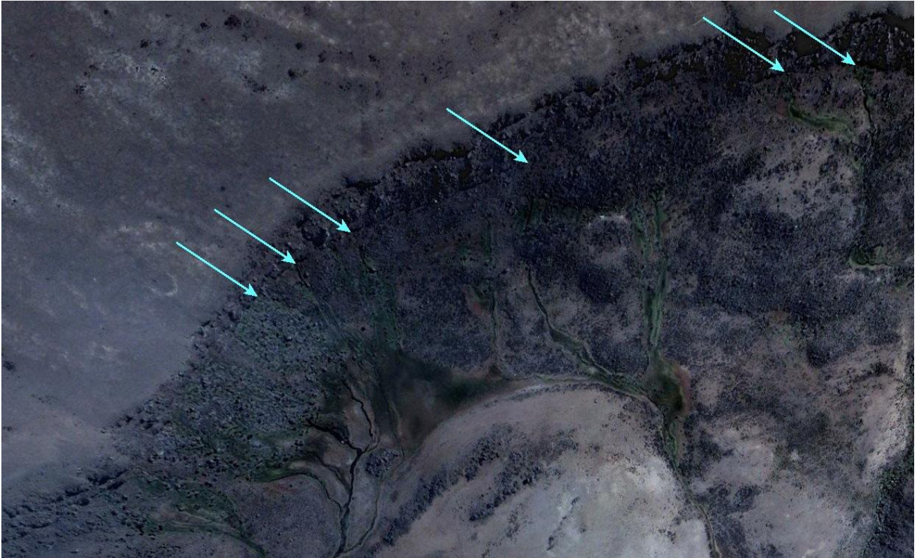
Figura 4-92. Afloramientos del Freático de Meseta situados al oeste del área relevada. Se presentan como manantiales (señalados mediante flechas celestes), situados sobre la pendiente de la margen norte del valle del río Santa Cruz.
